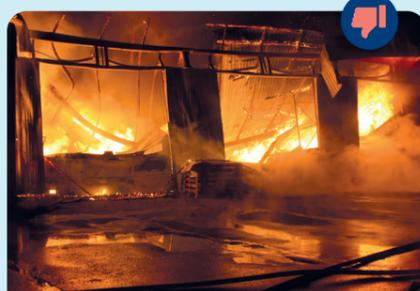
Incendie à la suite de projections enflammées d'une soudure, proche de matériaux inflammables.
